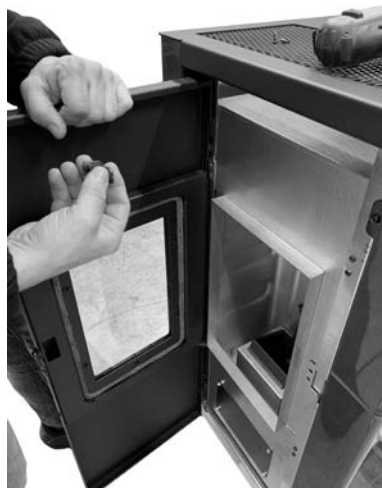
Fig. 29 - Retire la bisagra
