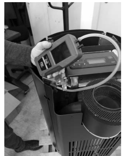
Fig. 66 - Conexión del presostato digital
