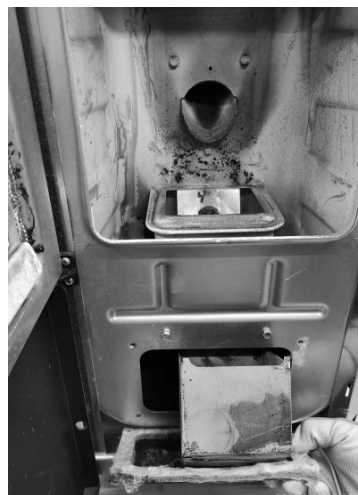
Fig. 72 - Retire la tapa de inspección
