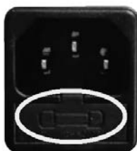
Fig. 78 - Ventanilla con los fusibles de remover
