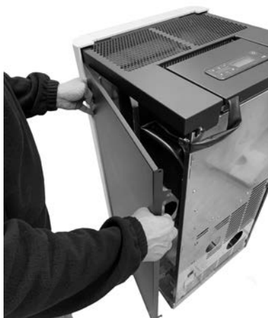
Fig. 35 - Desenganche las paredes laterales
