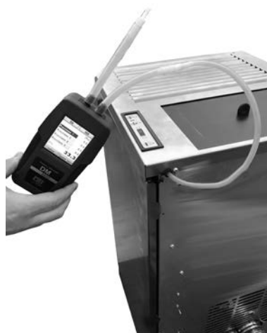
Fig. 65 - Conexión del presostato digital
