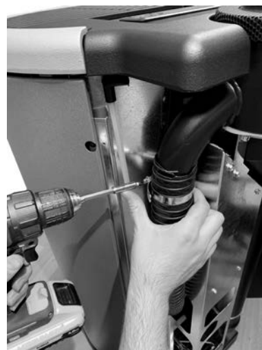
Fig. 58 - Retirar el tubo flexible
