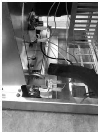
Fig. 77 - Limpieza ventilador ambiente
