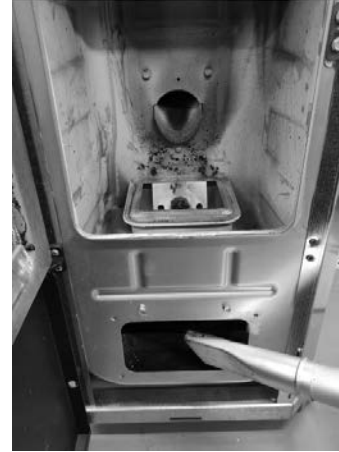
Fig. 74 - Aspire las cenizas
