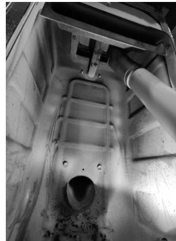
Fig. 76 - Aspire las cenizas
